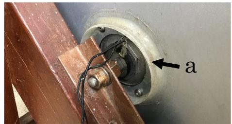
図 4 水車の回転軸の水よけ
